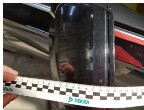
Fot. 60 Lusterko zewnętrzne lewe (Rysa/Odprysk)
