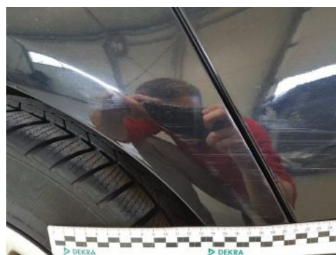
Fot. 46 Błotnik tylny prawy/ściana boczna prawa (Rysa/Odprysk 1)
