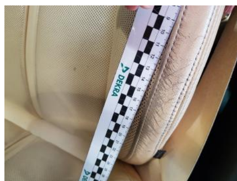
Fot. 64 Fotel lewy (Zarysowanie/Ubytki materiału)
