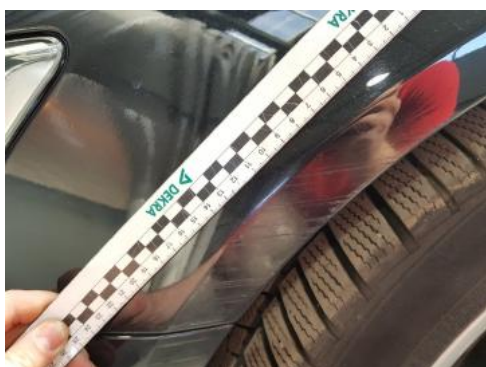
Fot. 61 Błotnik przedni lewy (Rysa/Odprysk)
