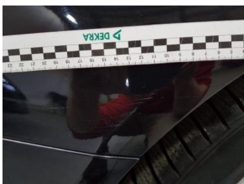
Fot. 47 Błotnik tylny prawy/ściana boczna prawa (Rysa/Odprysk 2)
