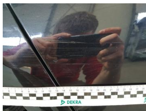
Fot. 44 Drzwi tylne prawe (Rysa/Odprysk)
