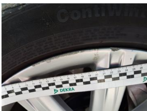
Fot. 63 Felga przednia lewa (Rysa/Odprysk)
