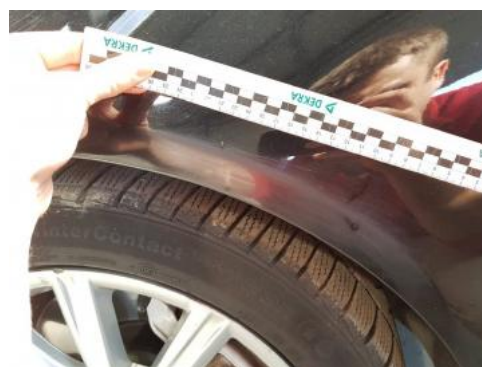
Fot. 62 Błotnik przedni lewy (Rysa/Odprysk 1)
