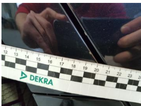
Fot. 45 Błotnik tylny prawy/ściana boczna prawa (Rysa/Odprysk)
